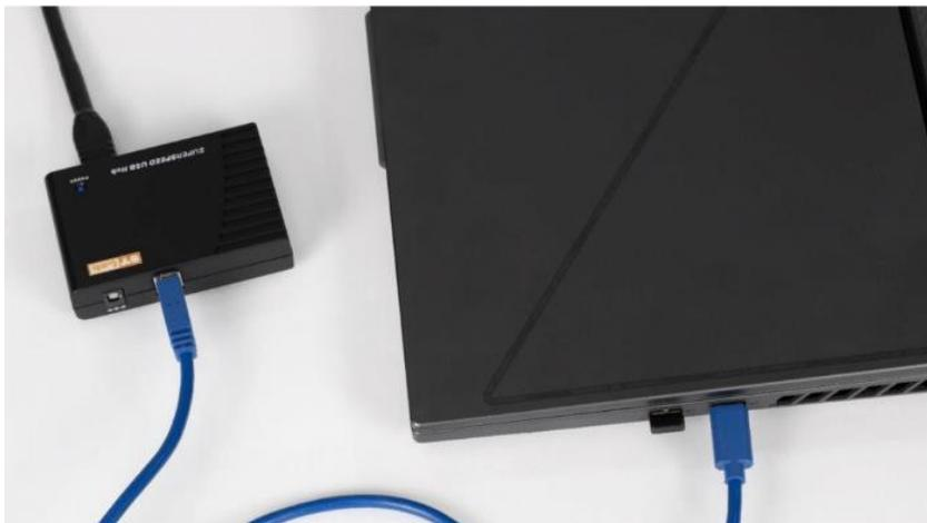
Figura 1: Ligue a extremidade do conector USB-A do conjunto de cabos fornecido ao Super Speed Hub.
