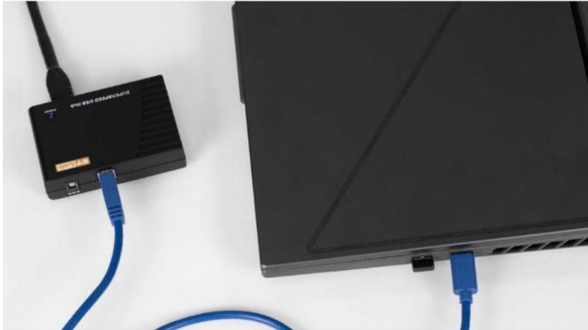
Figura 1: Enchufe el extremo del conector USB-A del haz de cables suministrado en el Super Speed Hub.
