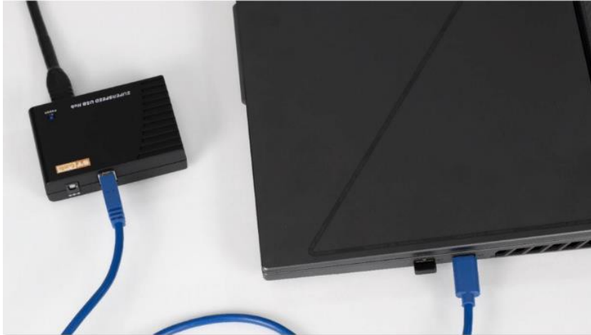
Figur 1: Plugg USB-A-kontakten på den medfølgende kabelbunten inn i Super Speed Hub.
