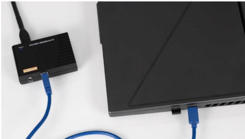
Abbildung 1: Stecken Sie das USB-A-Steckerende des mitgelieferten Kabelbündels in den Super Speed Hub.
