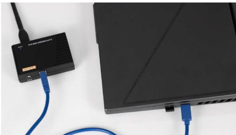
Ilustracja 1: Podłącz końcówkę złącza USB-A dostarczonego kabla do koncentratora Super Speed Hub.
