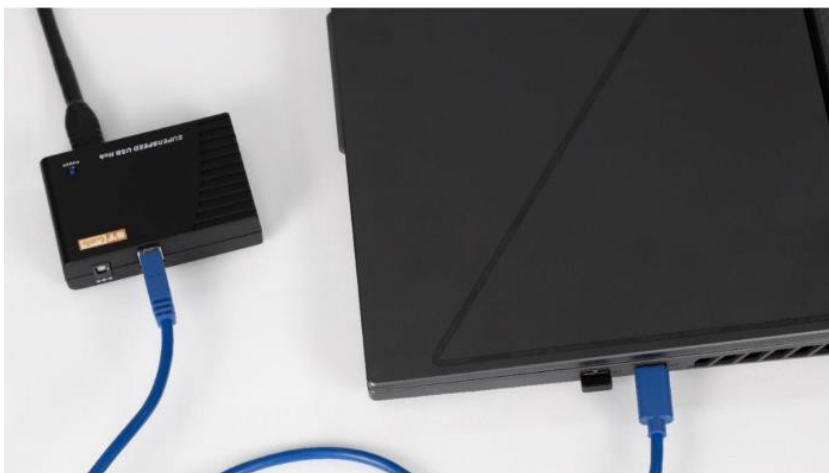
Obrázek 1: Zapojte konec konektoru USB-A dodaného svazku kabelů do rozbočovače Super Speed Hub.
