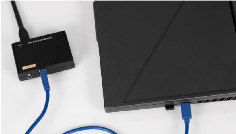
1 ábra: Dugja be a mellékelt kábelcsomag USB-A csatlakozóját a Super Speed Hubba.
