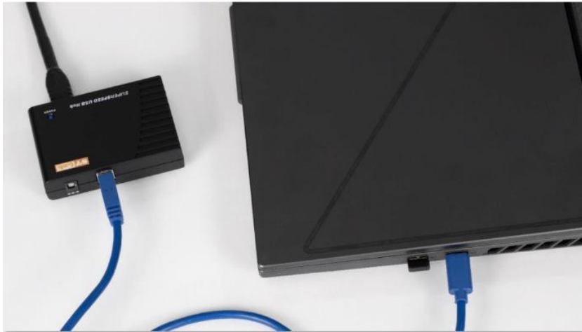
Kuva1 : Liitä mukana toimitetun kaapelipaketin USB-A-liitin Super Speed Hubiin.
